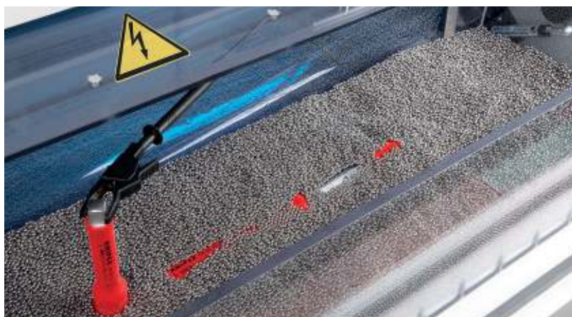
Zkouška vlastností elektrické izolace.
