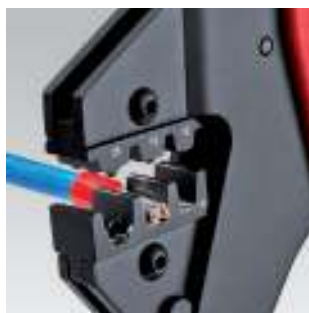
97 43 200 s lisovacím nástavcem 97 49 09 pro koncové dutinky kabelů
