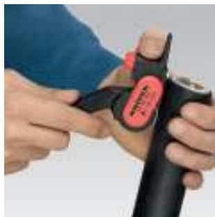
Nasazení nářadí pro odstřížení v podélném směru
