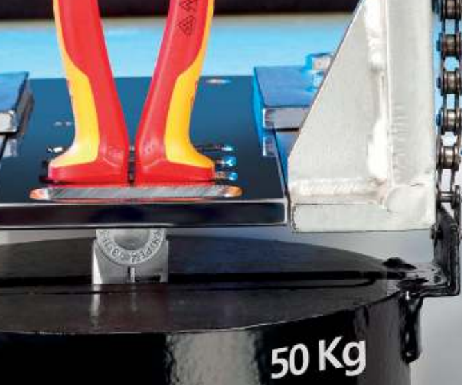
Zkouška přilnavosti izolovaných rukojetí s 500 N.
