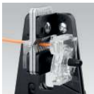
Čistě naříznutí izolace po celém obvodu
