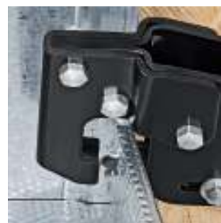
Lisovací nástroj je stlačován profilovanými plechy
